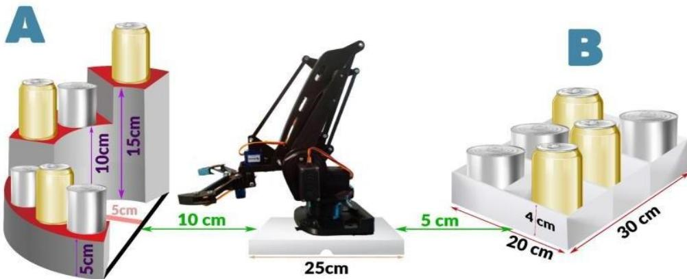
El punto “A” será una plataforma curva con 3 niveles con un ancho aproximado 15 cm y una altura escalonada de entre 15 cm y 5 cm y cada peldaño tendrá un ancho aproximado de 10 cm. El punto “B”, será una caja de 20 cm de ancho por 30 cm de largo y 4 cm de alto, con divisiones interiores.
